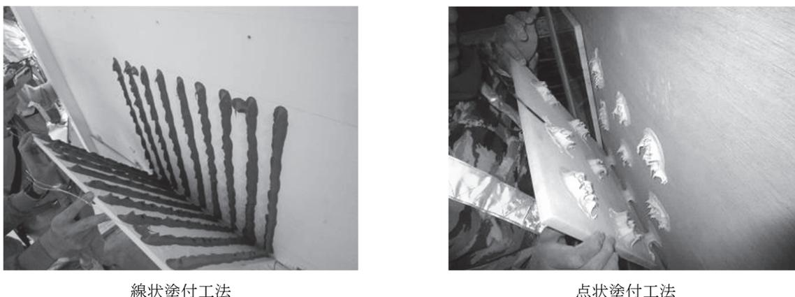
写真 1.3 タイル張り直後にタイルをはがした際の接着剤の状態
